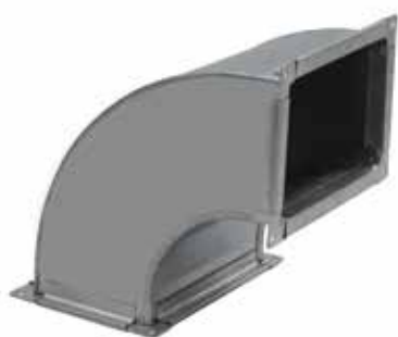
Отвод 90° (Пря.) – тип – A \times B \times s \times (R \text{ или } C \times D) По умолчанию для тип1, R = 150 мм и для тип2, D=C=150 мм
