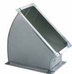
Отвод 45° (Пря.) – тип – A \times B \times s \times (R \text{ или } C \times D) По умолчанию для тип1, R = 150 мм и для тип2, D=C=150 мм
